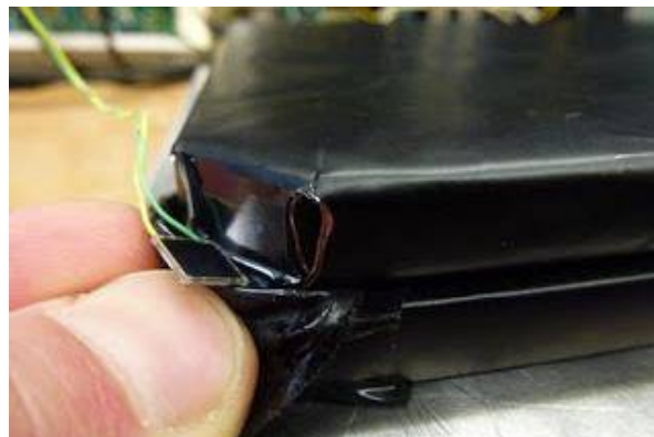
Fotomultiplicador de silicio en una esquina de la placa del centellador.
